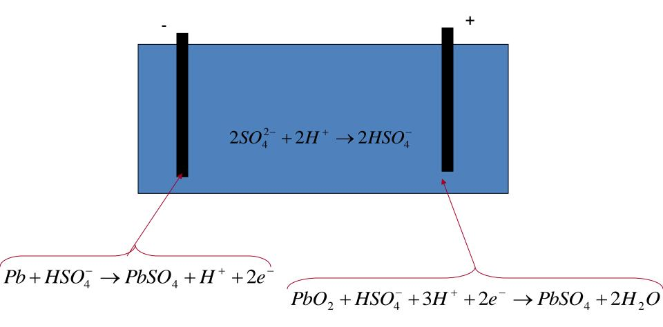
Net Effect  $Pb + PbO_2 + 2(2H^+ + SO_4^{2-}) \rightarrow 2PbSO_4 + 2H_2O$
