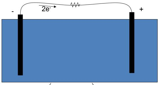
$Pb + PbO_2 + 2(2H^+ + SO_4^{2-}) \rightarrow 2PbSO_4 + 2H_2O$
